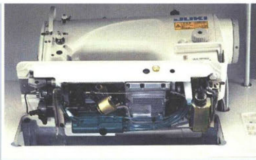
高速回転の際に起きる部品の焼き付きを防止するため下部はオイルに浸っていたが、現在は必要な部分だけにグリスが密封されたいわゆる「ドライミシン」が主流になりつつある。
