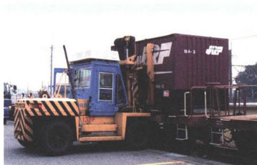
貨物コンテナの鉄道輸送では、コンテナとコンテナ貨車にRFタグを取り付け、輸送中のコンテナ所在がわかるようなシステムが稼動している。(写真提供：日本貨物鉄道(株))
