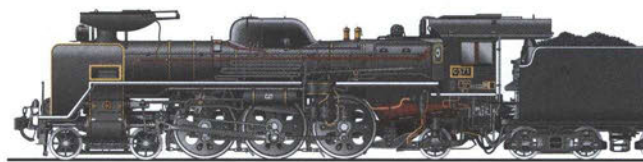
車輪は、車両を駆動する動輪を中心に、前に先輪、後ろに従輪が配置されている。 (イラスト制作: 鈴木 信雄「遠い汽笛」www.linkclub.or.jp/~snobu/)
