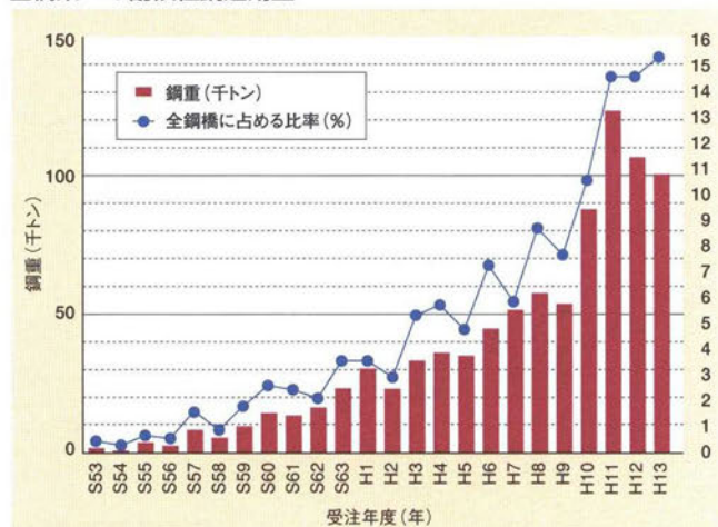
■橋梁への耐候性鋼適用量
