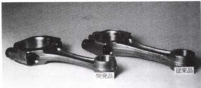
図4 高疲労強度非調質鋼によるコンロッドの軽量化事例 7)
