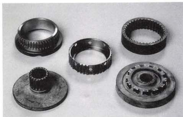
図8 熱冷複合鍛造品によるネットシェイプ化事例 5)
