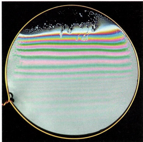
図1 シャボン膜に見られた干渉色写真 外径80mmの針金枠に石鹼液膜を作ると、上になった部分の石鹼膜が薄くなり、膜厚に傾斜を生じ連続した干渉色が観察される。明瞭な色を得るために、背景を暗くして撮影した。
