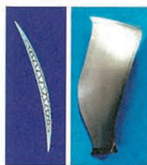
B787に搭載候補となっているエンジンTrent1000には、中空チタン製動翼が採用予定となっている。(写真提供:ロールス・ロイス・インターナショナルリミテッド、(株)日本航空技術協会)
