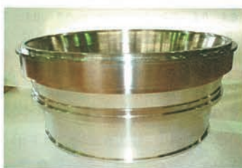
A380に搭載候補となっているエンジンTrent900の中圧圧縮機ケースには、チタン製リング品(外径:約φ1200mm、高さ:500mm、材質:Ti-6Al-4V合金)が採用されている。(写真提供:(株)神戸製鋼所)
