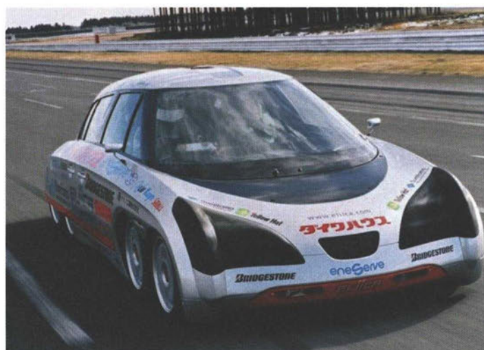
開発が進む電気自動車「Eliica」。停止から時速100kmまでの加速時間は4.1秒、時速160kmまでは7.0秒となっている(記録挑戦車の場合)。(写真提供:慶應義塾大学)
