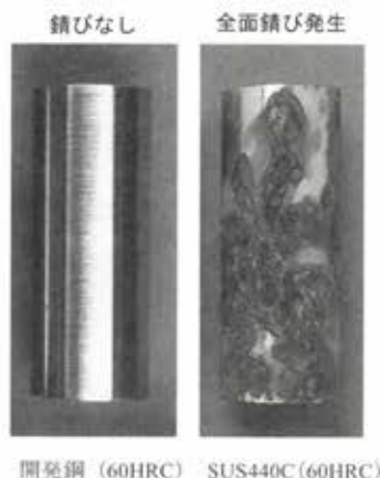
図2 開発鋼と従来鋼の塩水噴霧試験後の外観 (35℃、5%塩化ナトリウム溶液96時間噴霧)
