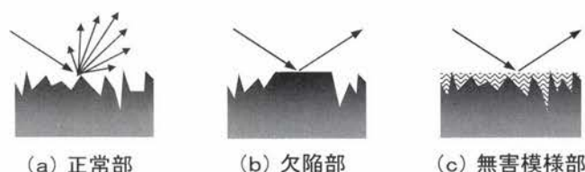
図4 鋼板表面各部の光学モデル
