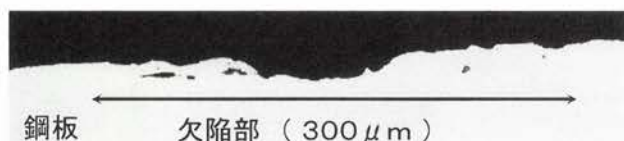
図3 表面欠陥断面の電子顕微鏡写真例
