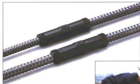
機械式継手の例（カプラーとナットで接合し、グラウト材を注入することにより固定する方式）
