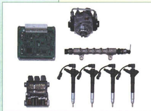
180MPaコモンレールシステム。応答性にすぐれたピエゾ素子を採用し、最短噴射間隔はわずかに1万分の1秒である。(資料提供: (株)デンソー)
