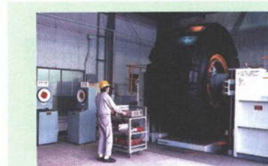
試験機を使ったホイールの応力測定
