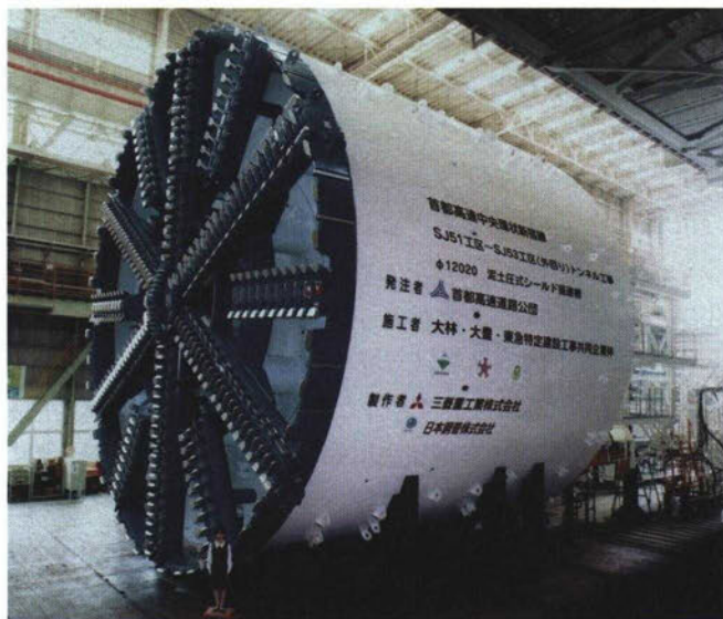
泥土圧式シールドマシン (左写真) とその基本構造 (上図)
