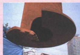
使用された回転杭の先端羽根形状
