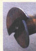
使用された回転杭の先端羽根形状
