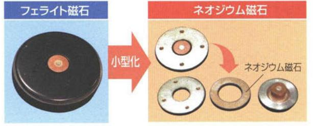
フェライト磁石(直径80mm)から磁力の高いネオジウム磁石を採用することで小型化を実現(直径50mm)。スピーカーの薄型化を可能にした。
