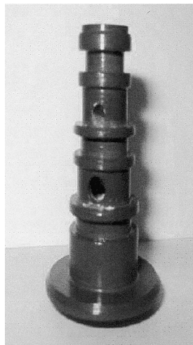
図2 低炭鉛フリー快削鋼の採用部品例：自動車用自動変速機部品
