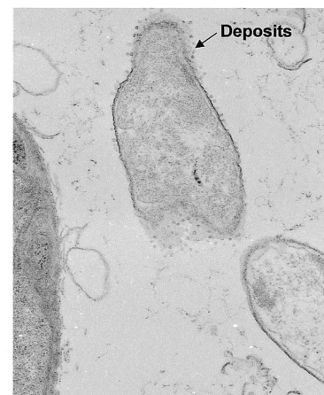
写真9 Ag含有ステンレス鋼表面に付着したシュードモナス菌の変形のTEM写真
