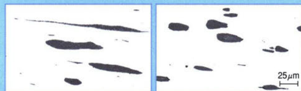
開発鋼(左)の硫化物は硫黄複合快削鋼(右)に比べ大型化している。
