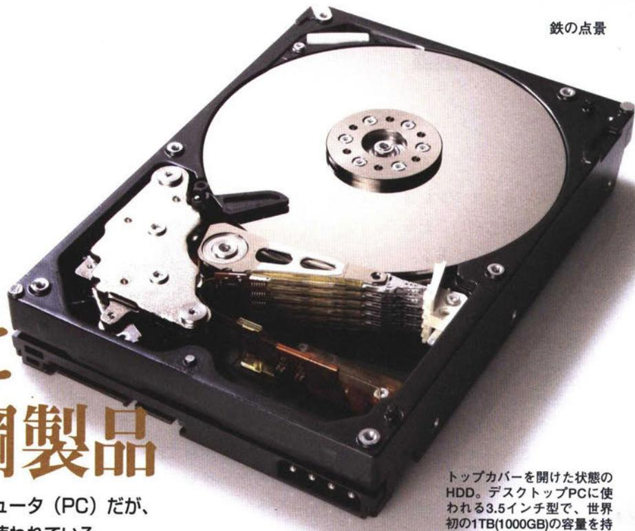
トップカバーを開けた状態のHDD。デスクトップPCに使われる3.5インチ型で、世界初の1TB(1000GB)の容量を持つ「Deskstar 7K1000」(株式会社日立グローバルストレージテクノロジーズ)
