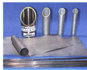
耐海水性ステンレス鋼の加工例
