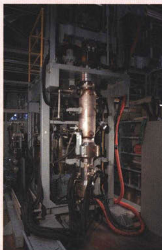
最大電流:3000A 圧力装置:0.1~5MPa N_2 ガス仕様 鋼塊サイズ:直径100mm×長さ320mm以下 (20kg以下)
