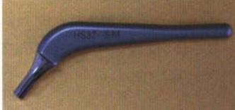
ニッケルフリー高窒素ステンレス鋼の応用例。人工関節（上）音楽器用マウスピース（右）
