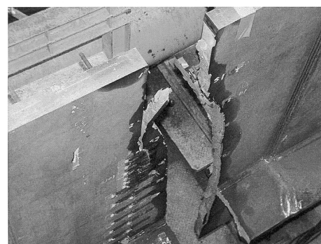
図6 アレスト性を特に考慮しない母材による大型脆性亀裂伝播停止試験結果の例
