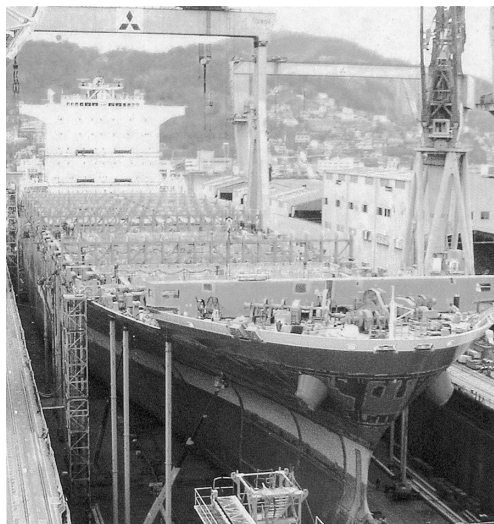
図8 47HTを初めて適用した8,100TEUコンテナ船
