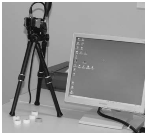
図18 一般化Hough変換を用いた回転サーチ器
