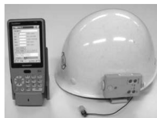
図2 騒音下音声認識を実現するイヤーマイクヘッドセットと携帯端末
