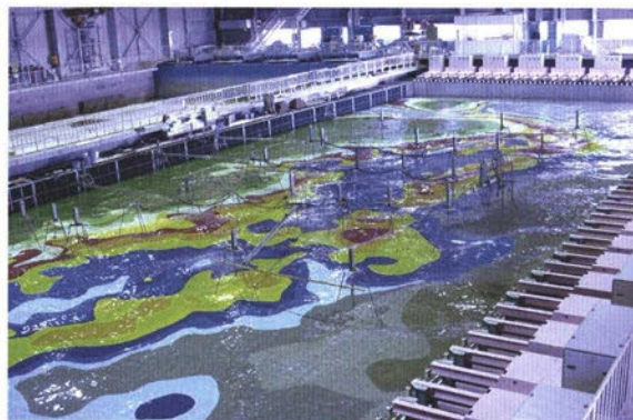
長周期波の発生メカニズムや港内への侵入についての造波装置による実験(資料提供:(独)港湾空港技術研究所)
