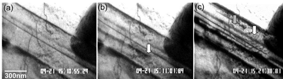
図10 転位移動・増殖のHVEMその場観察結果(シリコン結晶)。(a) (b) (c) はビデオ取り込み像。(b) (c) はそれぞれ、(a) の7秒後、10分20秒後の同一視野における像
