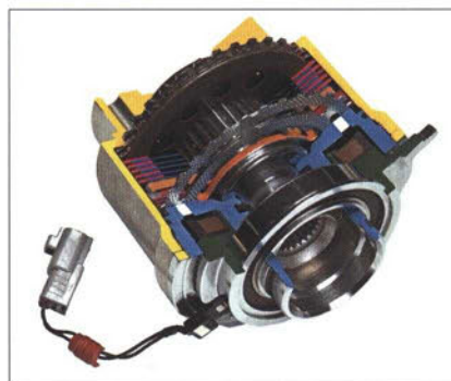
4WDカップリングの カットモデル
