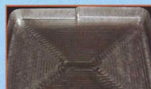
DLCを被覆したエンドミルで加工したワーク
