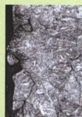
粒界部分から割れ発生。
