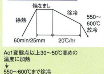
刃物鋼のヒートパターン事例
