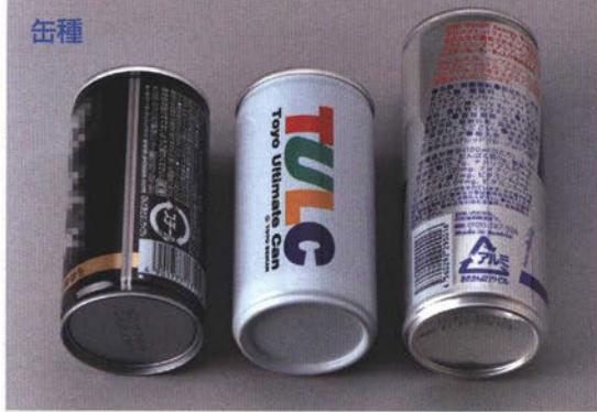
(写真左から) 3ピース缶、2ピース缶(TULC)、2ピース缶(アルミDI缶)。中央のTULCは2ピースの陰圧缶。陰圧缶は中身充填後、漏れなどがないか底を叩いて検査(打検)するため、底が必ず平らになっている。陽圧缶の主流はアルミDI缶で、スチール製陽圧缶の生産量は少ない。
