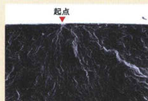
通常の疲労破壊の起点。1箇所の微細な起点から塑性変形によって次第にき裂が成長する。
