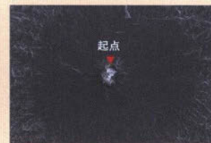
ギガサイクル疲労破壊の起点。内部にある介在物が起点(フィッシュアイと呼ばれる)となりき裂になっていく。破面は材料内部のため黒く見える。
