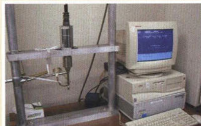
20kHz超音波試験機。1秒当たり2万回(20kHz)の繰り返しサイクルが可能で、極めて高速でギガサイクル疲労試験を行うことができる。
