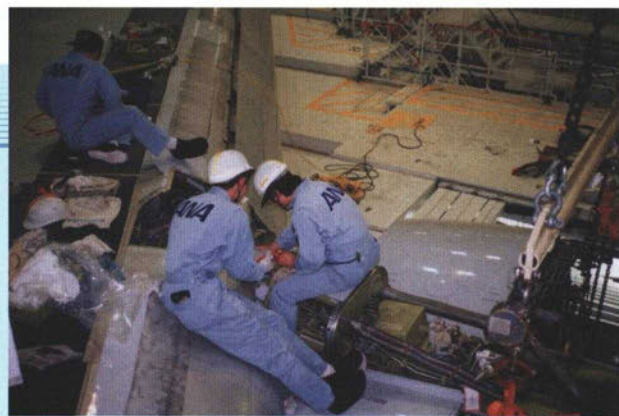
機体の各部はセンサーによってモニターされているほか、内視鏡(ボアスコープ)などによる目視検査も行われている。
