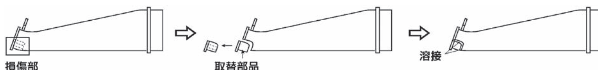
図5 燃焼器尾筒クーボンリペア
