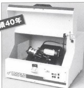
SPEX No.8000M ミキサーミルは独自の8字回転系により、硬質なサンプルの粉碎、混合に威力を発揮します。世界中の研究者、現場で愛用されています。
