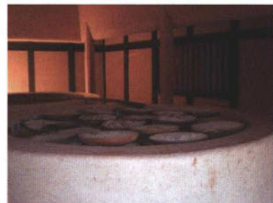
明治の頃のベンガラ工場を復元。釜場室では、乾燥させたローハを焼く。ローハは少量ずつ盛り、土窯の中に積み重ね松の薪を使い、約700°Cで1~2日ほど焼く
