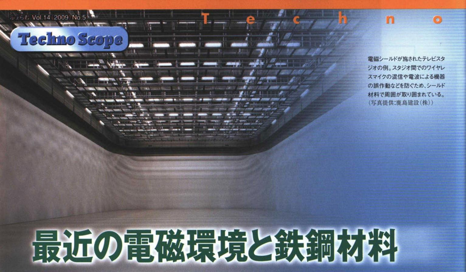
電磁シールドが施されたテレビスタジオの例。スタジオ間でのワイヤレスマイクの混信や電波による機器の誤作動などを防ぐため、シールド材料で周囲が取り囲まれている。
