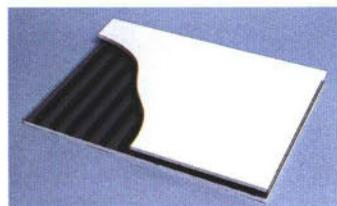
電磁波を吸収するフェライトタイルを使用した外壁材。フェライトタイル上の溝の間隔を調整することで、吸収させたい電磁波の周波数を制御したり、電磁波が放射されてくる方向に対して最適な吸収性能を持たせたりすることができる。
