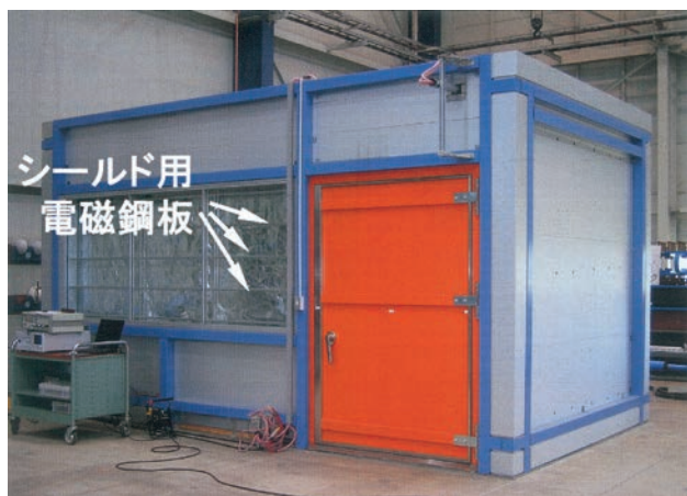
図12 実機規模の磁気シールド室
