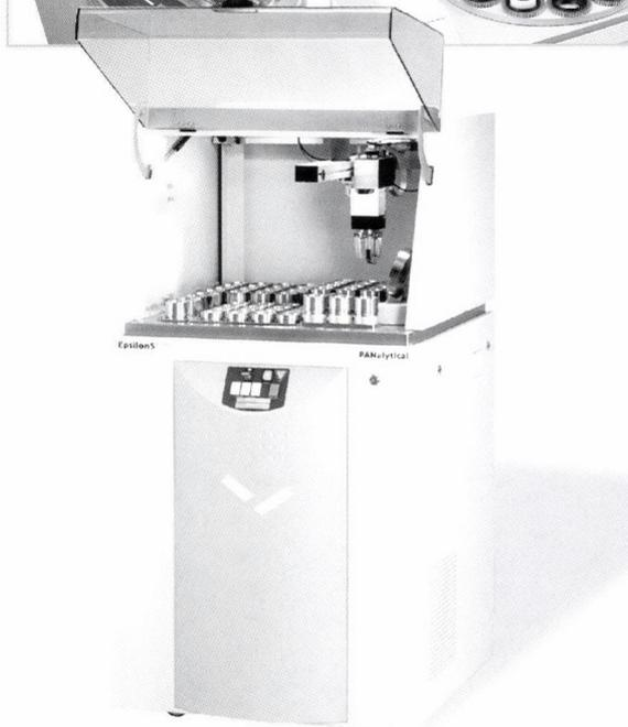
微量重金属分析用エネルギー分散型蛍光X線分析装置
