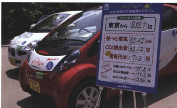
2008年6月に行われた「CO 2 削減EV洞爺湖キャラバン」(日本EVクラブ主催)では東京から洞爺湖までの858.7kmを電気自動車が走行し、電気代は1,713円、CO 2 排出量は35.12kgであった。同時期にガソリン車で走行した場合、ガソリン代は12,956円(172円/ℓ)、CO 2 排出量は174.6kgとなる。(資料提供:日本EVクラブ、撮影:三浦康史)
