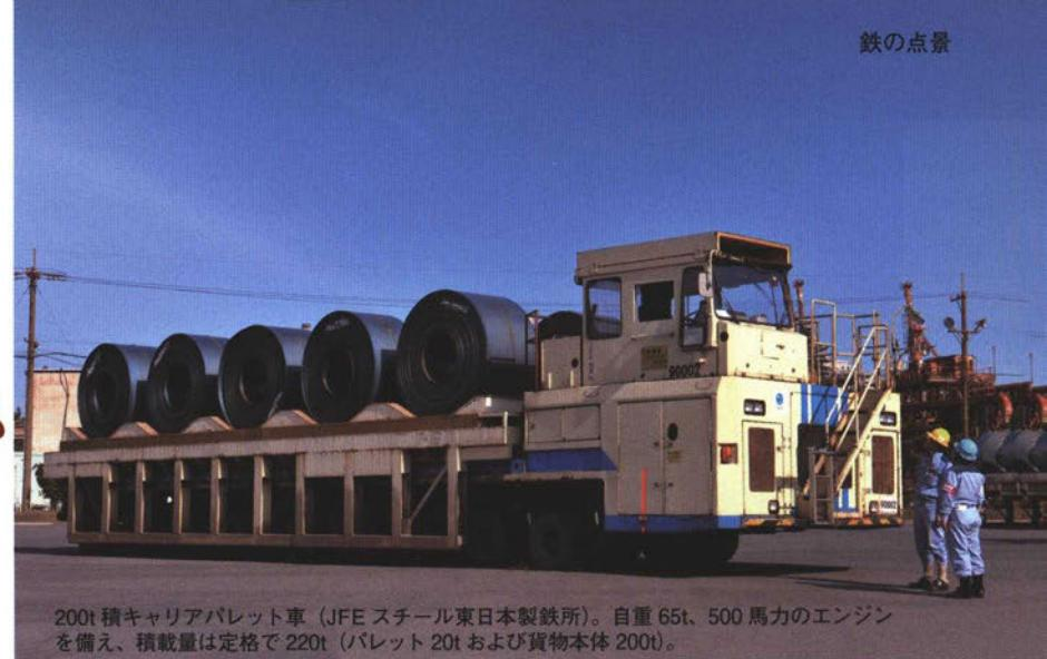
200t 積キャリアパレット車 (JFE スチール東日本製鉄所)。自重 65t、500 馬力のエンジンを備え、積載量は定格で 220t (パレット 20t および貨物本体 200t)。
