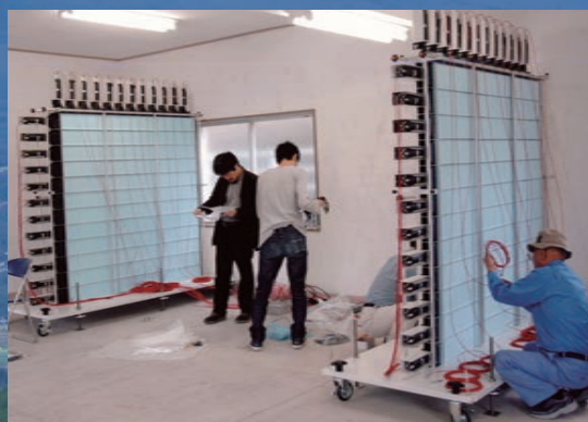
透過してきたミュオンの数を観測する検出器 南日本新聞2009年2月28日より
