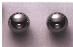
地球上で最も丸いと言われる ベアリングの鋼球 (写真提供: 日本精工(株))
