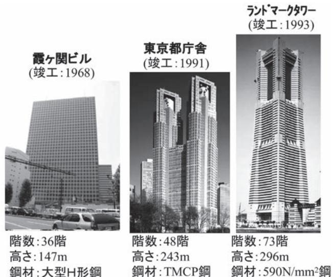
図2 超高層化を支えた鉄鋼材料
