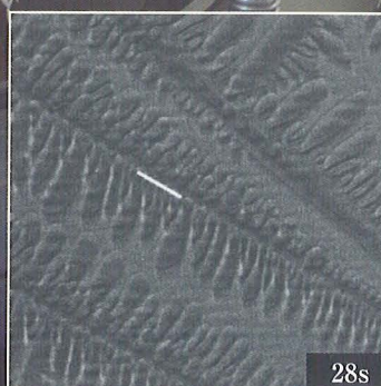
炭素鋼の凝固過程について、SPRING-8でその場観察した結果。凝固が進むにつれデンドライトが粗大化し凝固組織が形成されていく様子が観察された。(資料提供:大阪大学大学院・安田秀幸教授)
