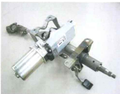
【写真4】コラムアシスト型電動パワーステアリング
