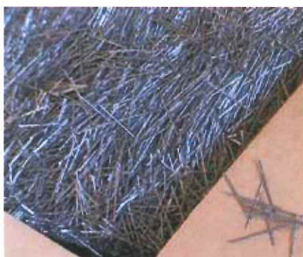
スチールファイバー スチールファイバーを用いたコンクリート舗装は、「ファイバー強化コンクリート舗装=Steel Fiber Reinforced Concrete」の略で「SFRC」とも呼ばれる。
