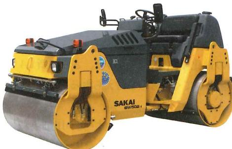
それぞれ車幅の前後2つの鉄輪を持つタンデムローラ。運転質量約4t、締固め幅1.3mの中型で、振動機能も持つ車種。
