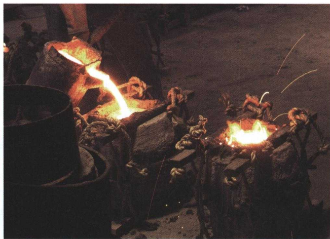
釜の制作では、鉄を溶解することを「ふき」と呼び、ふいた鉄は「湯」と呼ばれる。1500℃以上で溶かされた「湯」は鋳型に注がれる。
