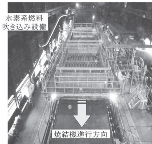
図 Super-SINTER™ の概要写真
