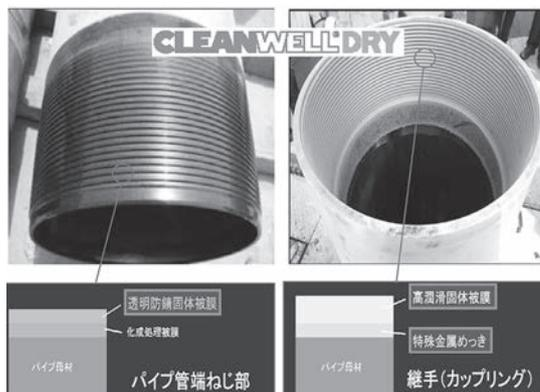
図 CLEANWELL®DRY の構成
