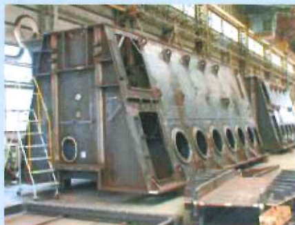
架構や台板の溶接工程。曲げやよじれに強い構造ができあがっていく。
