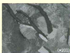
ねずみ鋳造（片状黒鉛鋳鉄）の組織 (×200)
