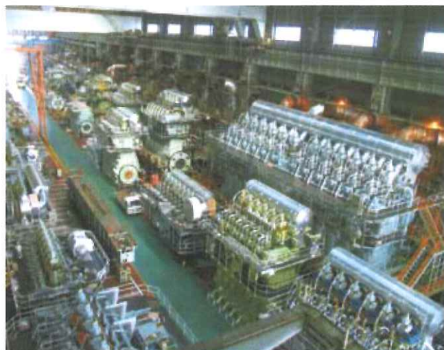
ディーゼル機関は、搭載される船の種類や最高速度によって仕様が決まる。現在は、シリンダボア50cm程度の中型エンジンの需要が高まっている。組立工場では、生産性の高いラインを整備し、高い信頼性とコストダウンを両立している。
