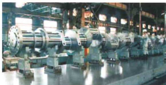
中型船舶向けの一体型クランク軸は特殊鍛造により作られる。材料は、以前は450MPa級炭素鋼などが多かったが、最近は低合金鋼の比率が高まっている。また950MPa級の高強度材料の使用が進んでいる。疲労強度向上のため高周波焼入れ、窒化、ショットピーニングなどが適用されることがある。
