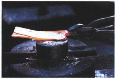
2枚の材料を重ねたまま鍛造する「二枚広げ」は、越前打刀物の特徴的な製造工程である。(写真提供：越前打刀物協同組合)
