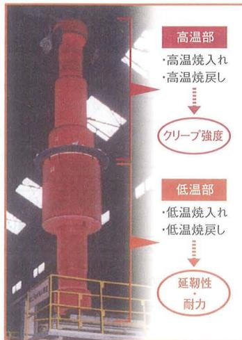
高低圧一体型タービンロータは、高圧、中圧、低圧ロータを一体化することで、大幅なコンパクト化を図っている。材料は高低圧一体型タービンロータ用に開発された材料が使用されている。高圧部、低圧部でそれぞれ必要な材料特性を1本のロータで機能させるため、傾斜熱処理技術が開発されている。これは熱処理条件を変えることで部位ごとに異なる特性を付与するもので、高温部は高温焼入れ・高温焼戻しを行い、高温クリープ強度を向上させ、低温部は低温焼入れ・焼戻しを行い、延塑性等を向上させている。(資料提供:(株)東芝)
